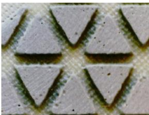
Brusný disk 100% otevřený (po několika minutách broušení)
