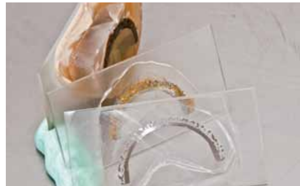
Der Weg zum Dünnschliff – Beispiel eines Titan Pfannenimplantates
