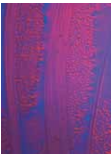
GFK Dünnschliff Polarisationsmikroskop
