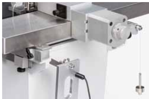
Parallelführung mit präziser Vorschubeinstellung und automatischer Probenzustellung
