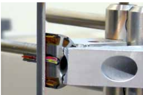
Diamant-Band: Trennen und Schleifen in einem Arbeitsgang
