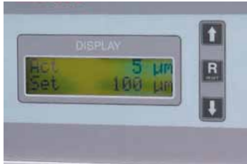
µ-genaue Einstellung und Messung des Abtrages
