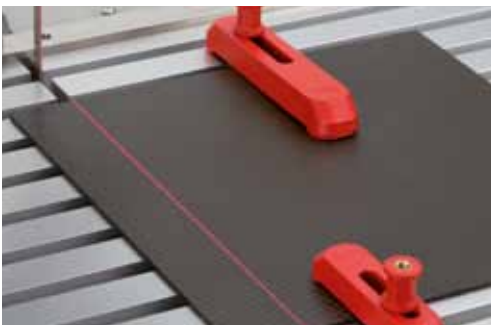
EXAKT 311 – Zuschnitt von CFK Streifen für Zugversuch
