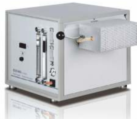
Analyzátor s odporovou pecí pro analýzu zbytkového vodíku v kovech.
