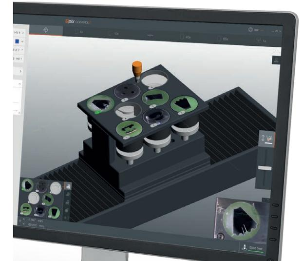
Bei Verwendung von Qness Probenhaltern ermöglichen die CHD Master+ Modelle Härteprüfungen an bis zu 8 gebetteten Proben gleichzeitig – auch bei mehreren Prüfteilen in einem Schliff.
