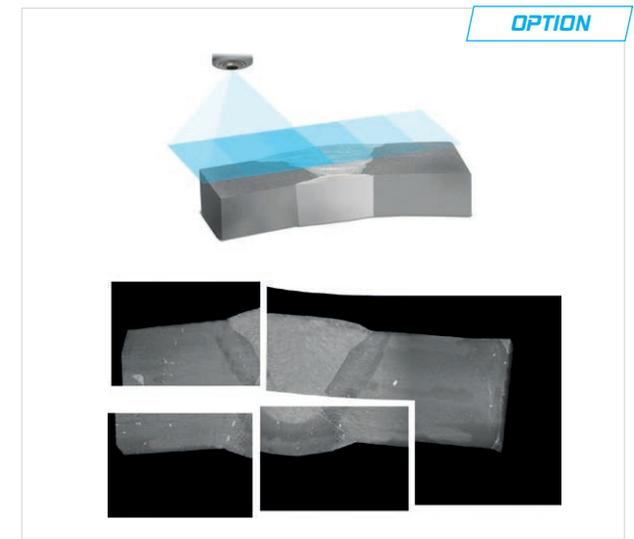
Geschaffen für schnelle und einfache CHD/NHD/SHD-Verläufe sind optional auch Schweißproben und Visuelle Prüfmuster für besonders große Bauteile möglich.
