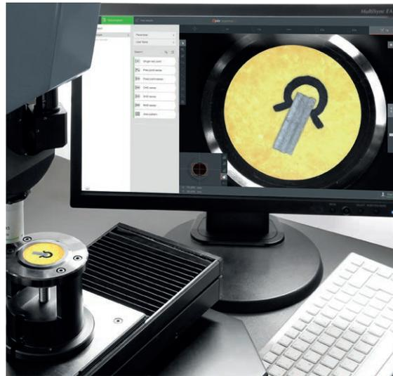
Ultimativer Bedienkomfort durch USB 3.0 - 5 Megapixel Farbkamera zur Aufnahme der gesamten Probe für perfekte Übersicht und Dokumentation im Protokoll.
