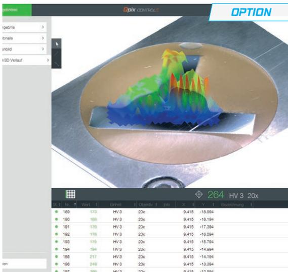
Härteverteilung über Segmente oder gesamte Flächen von wärmebehandelten Bauteilen. Grafische Farb-Darstellung in 2D und frei drehbarem 3D am Probenbild.
