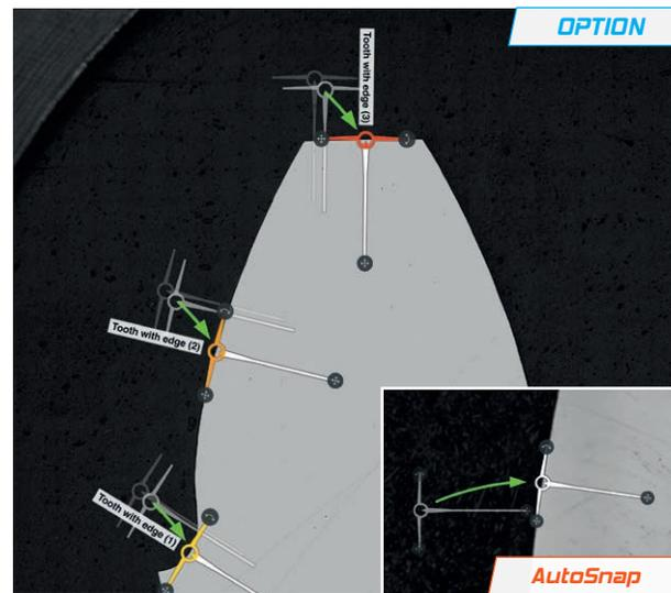
Funktion des Qness-Softwaremoduls „Randkantenerkennung“ ist die automatische Anpassung von Prüfreihenstartpunkten an die Probenkante bei Verwendung von Projekt- und Probenvorlagen. Das Modul steigert den Automatisierungsgrad nochmals deutlich und ist die optimale Erweiterung zur serienmäßigen AutoSnap Funktion.
