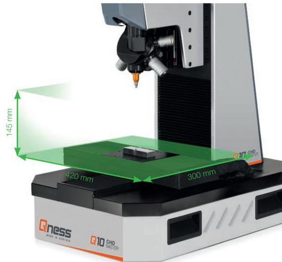
Die durchdachte Bauweise in eloxiertem Aluminium bietet einen großen und übersichtlichen Prüfraum. Der vollautomatische XY-Schlitten mit inkrementeller Wegmessung kann beispielsweise mit einem 1-fach Probenhalter bestückt werden.
