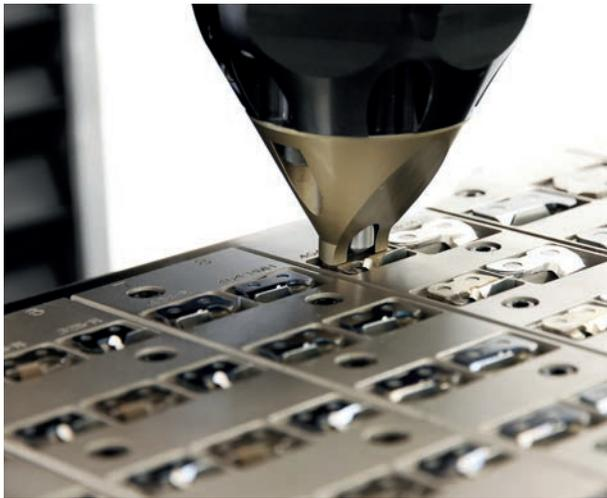
Wiederkehrende Proben können als Vorlage gespeichert werden. Über definierte Probenmagazine werden sämtliche relevante Daten wie Prüfmuster, Prüfmethode und Benutzerfelder aktiviert.
