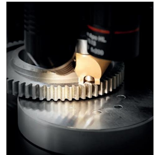
Die funktionell integrierte Arbeitsraumbeleuchtung ermöglicht eine genaue Positionierung des Eindringkörpers.
