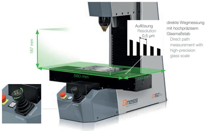
Die durchdachte Bauweise bietet einen großen und übersichtlichen Prüfraum. Der vollautomatische XY-Schlitten mit hochpräzisem optischen Wegmesssystem kann beispielsweise mit 2 Stück 8-fach Probenhalter bestückt werden. Darüber hinaus können in der Software auch kundenspezifische Magazine individuell verwaltet und angelegt werden.
