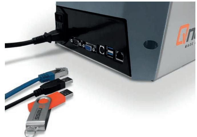
Vollständige Vernetzung und höchste Performance mit integriertem Windows-PC mit SSD Festplatte serienmäßig schon im Rockwell-Basisgerät Q150R. Kundenspezifisch sind Datenanbindungen und Integration in Fertigungslinien möglich.
