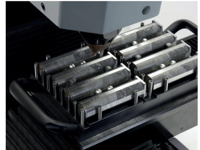
Mit dem 8 fach Jominy Probenhalter und dem zusätzlichen Jominy Prüfmodul können bis zu 8 Proben normgerecht vollautomatisch abgearbeitet werden.
