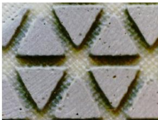
Brusný disk 100% otevřený (po několika minutách broušení)
