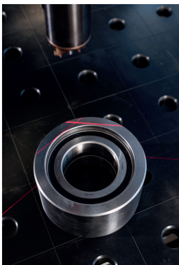
Kreuzlinienlaser mit Prüfspitze Cross line laser and testing mandrel
