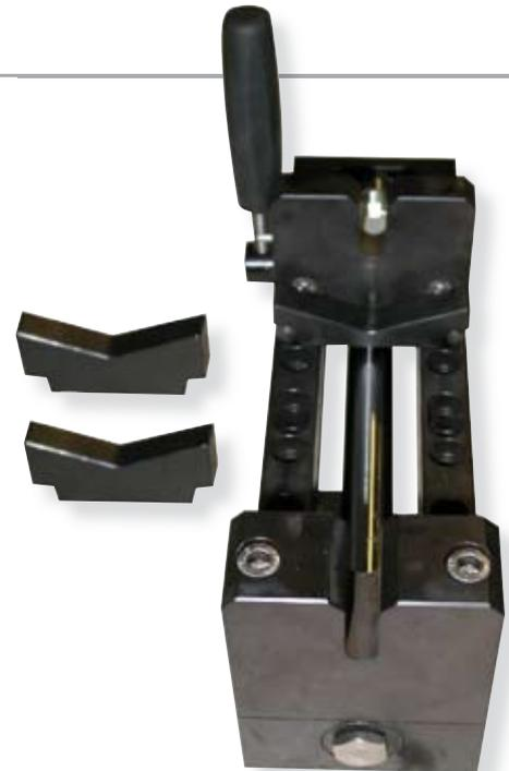
Für komplizierte Schnittführungen oder Geometrien haben wir erfolgreich Sonderspannwerkzeuge entwickelt. Sonderspannbacken und diverse Erweiterungen auf Anfrage erhältlich; z.B. Sonderlösung zum Trennen von runden Keramikbauteilen (Segmentschnitt).
